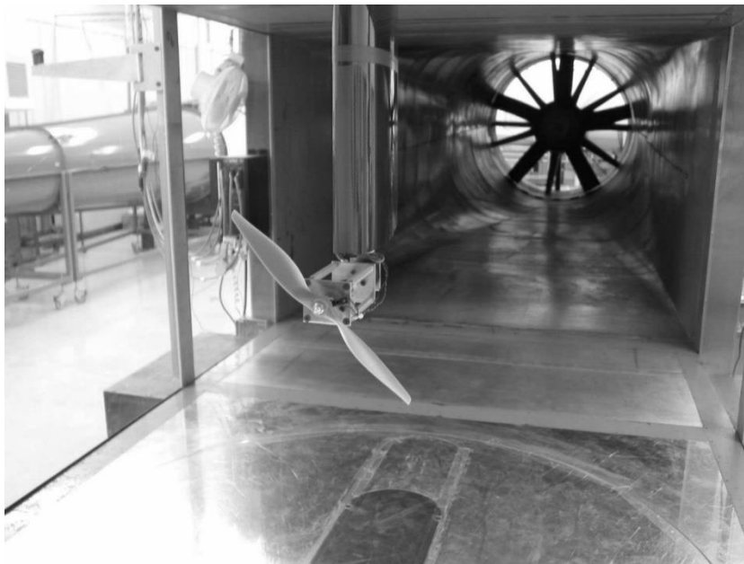
Obrázek č. 3: Měření vrtule v aero tunelu se snímači [3]
