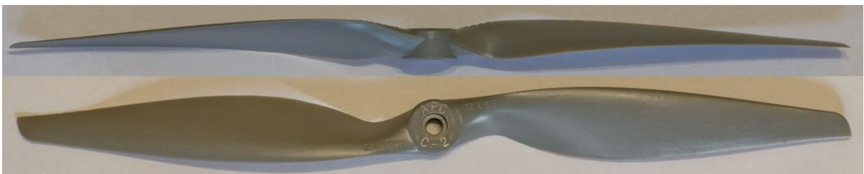
Obrázek č. 28: Vrtule APC 12x6E – vstupní fotografie do PropellerScanner
