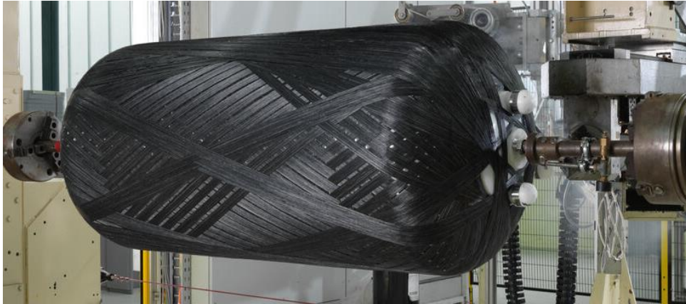
Obrázek 2.8 - Ukázka výroby vodního zásobníku z materiálu CFPR [17]
