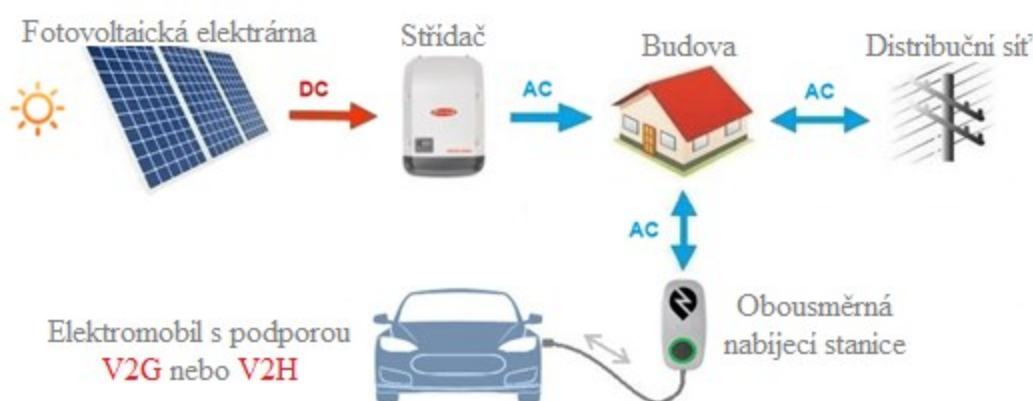
Obr. 2: Schéma systému V2H [3]
