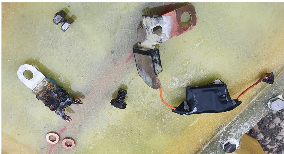
Obr. 9: Důsledek uvolněného šroubového spoje
