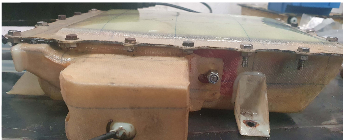
Obr. 13: Baterie s přetlakem uvnitř
