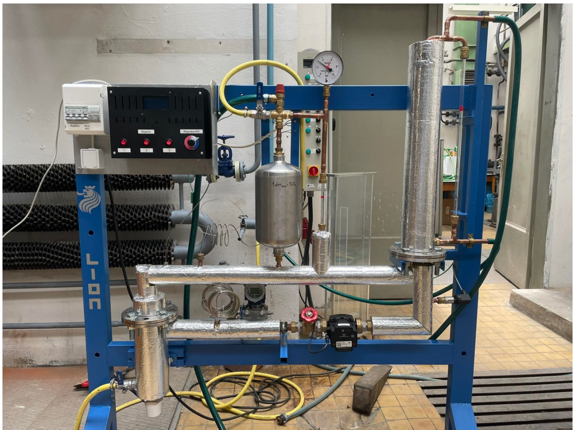
Obrázek 53: Smyčka s izolací
