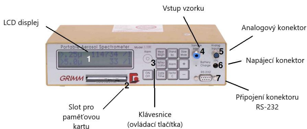
Obr. 35: Prvky na přední straně analyzátoru GRIMM 1.109 [67]
