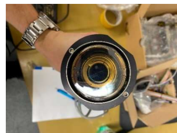
Obrázek 55 Původní fotonásobič (pohled na dopadovou plochu)
