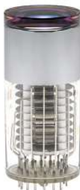
Obrázek 22 Příklad současného provedení fotonásobiče od firmy Hamamatsu [19]
