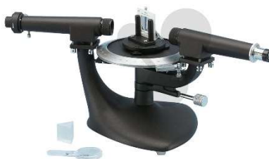
Obrázek 10 Současný goniometrický spektrometr založený na historickém principu [29]
