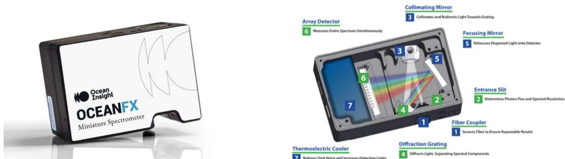
Obrázek 15 Vlákňový spektrometr od firmy Ocean Insight [37] Obrázek 16 Vnitřní struktura vlákňového spektrometru [36]
