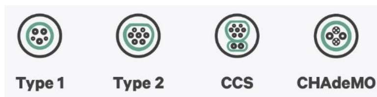
Obrázek 7 - Typy nabíjecích konektorů [67]
