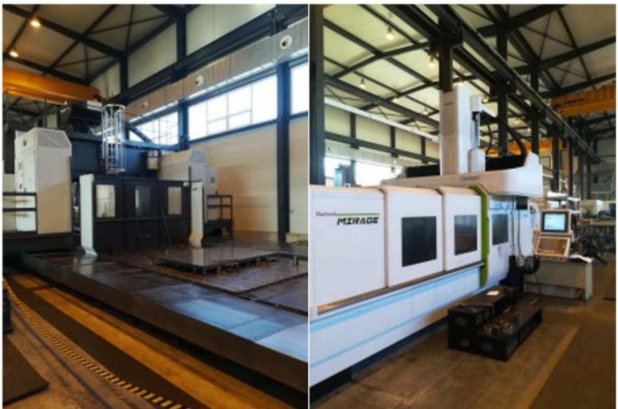
Obrázek 3-1 Portálové CNC Correa FOX M95 a Hartford HEP 3150
