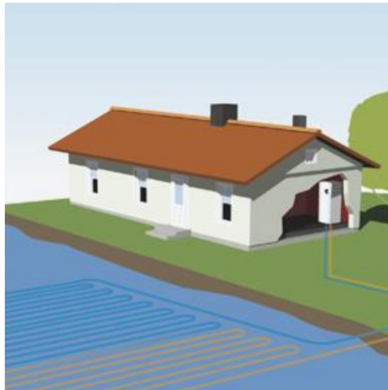
Obr. 2.15 Tepelné čerpadlo Voda/voda (vodní plocha) [13]
