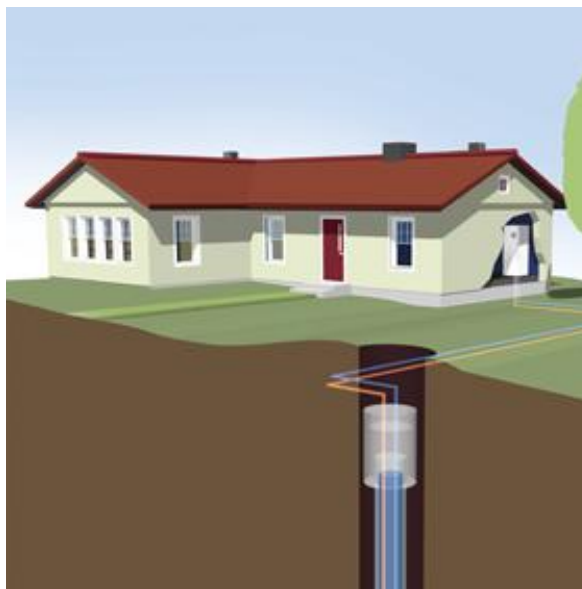
Obr. 2.12 Tepelné čerpadlo země/voda – vrt [13]
