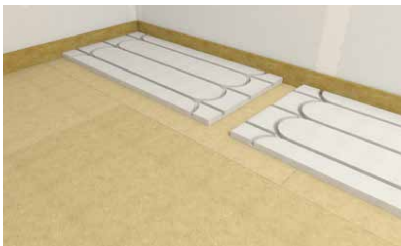
Pokládka prvků Gabotherm® Therm 25 (varianta 1) volně položených, spojovaných na tupo v křížové vazbě
