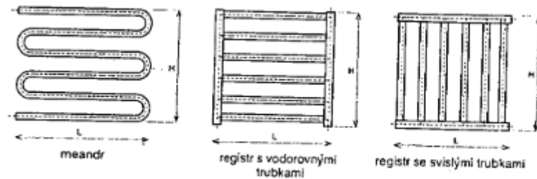
Obr. 6 - Uspořádání trubek u trubkového otopného tělesa [5]
