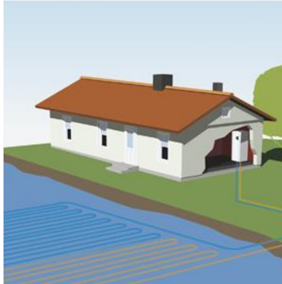
Obr. 18 - Tepelné čerpadlo voda/voda (povrchové vody) [12]
