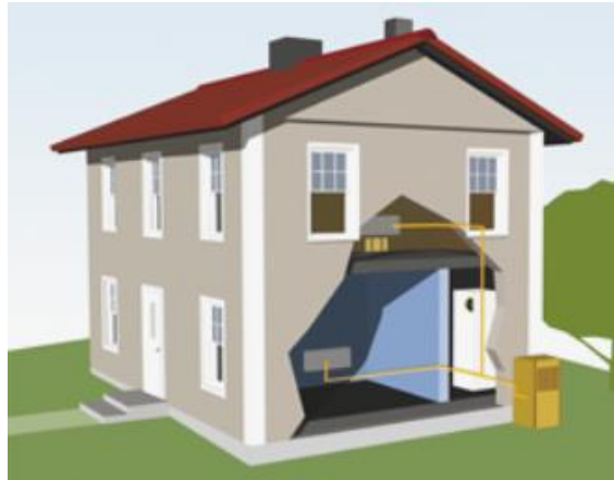
Obr. 14 - Tepelné čerpadlo vzduch/voda [9]
