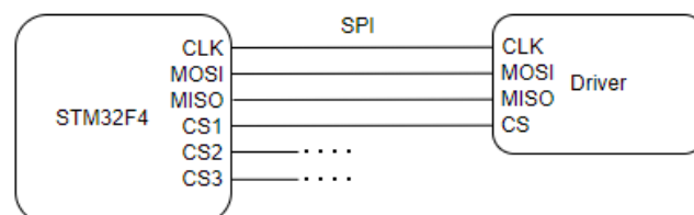
Obr. 61: Schéma komunikace SPI
