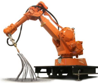
Obr. 12: 3D tisk termoplastu (kartézská konstrukce) [9] Obr. 11: 3D tisk kovů (kloubové rameno) [8]
