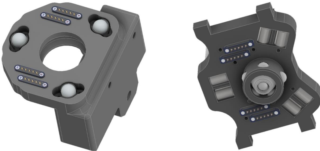
Obr. 40: Výměnná hlavice pro různé typy nástrojů Obr. 41: Nástrojová část se zamykacím mechanismem
