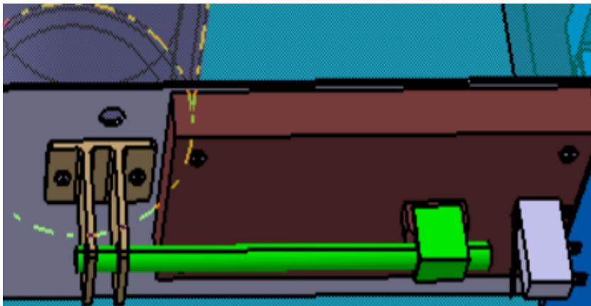
Obrázek 33: Zařízení odpojení boxu pomocí lineárního serva
