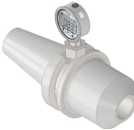
Obr. 6.7 Návrhový model upraveného držáku nástroje
