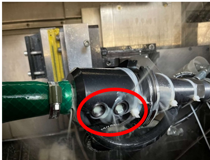
Obr. 5.2 Ukázka netěsnosti v držáku nástroje ve stroji SP430
