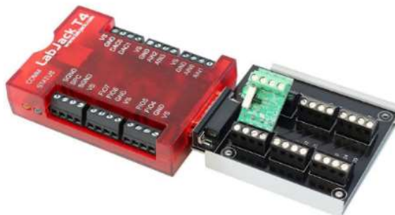
Obr. 7.2 LabJack T4 s rozšiřující svorkovnicí CB15
