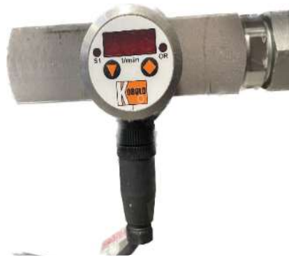
Obr. 3.3 Digitální průtokoměr Kobold VKM [19]
