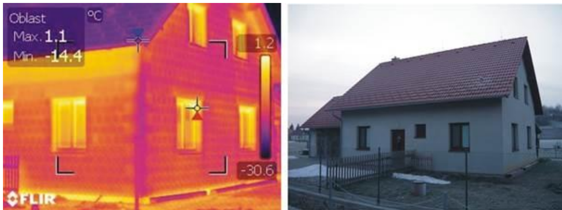
Obr. 1 Termogram obálky budovy [O1]
