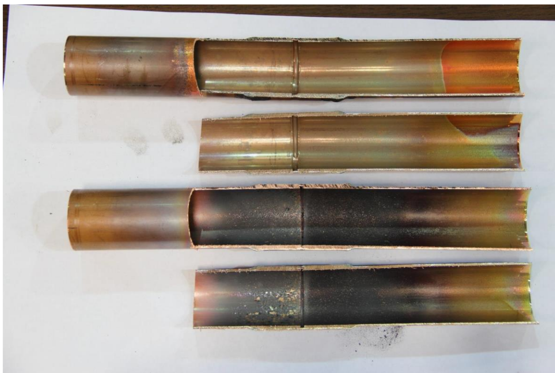
Obrázek 20 Rozdíl mezi pájením s kyslíkem (dole) a s dusíkem(nahoře) jako ochrannou atmosférou (15)
