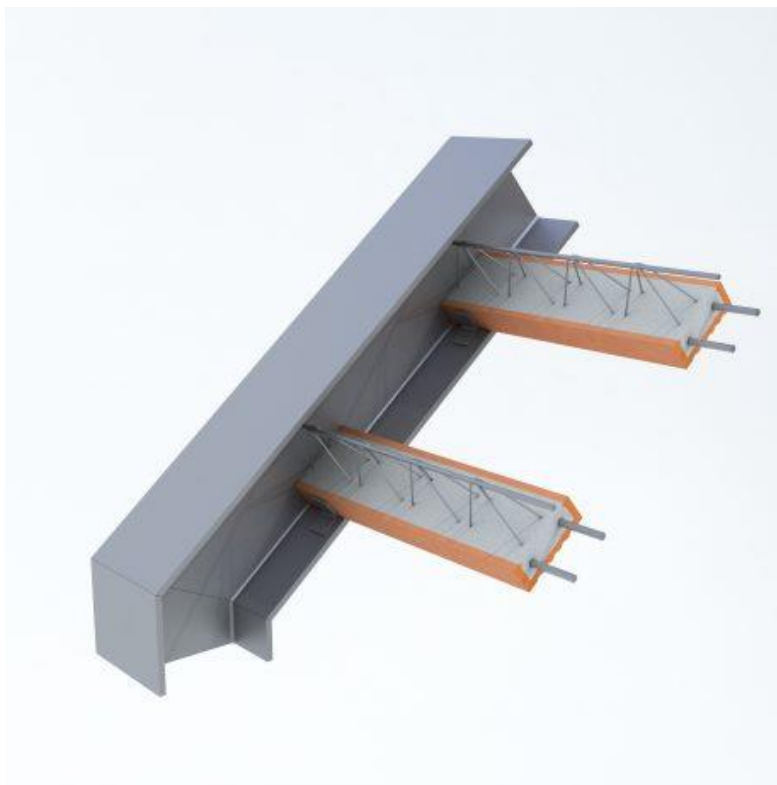
Obr. 2.20 Schéma uložení nosníku POT do ocelového rámu [7]
