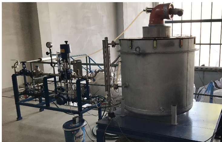
Obr. 28 – Generátor parovzdušné směsi použitý při experimentech. Výstup nad nádobou v pravé horní části fotografie byl připojen ke kondenzátoru spalin.
