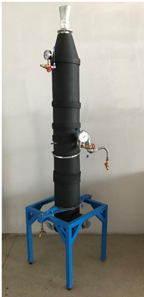
Obr. 26 – Spalinový kondenzátor osazený měřením teploty a tlaku použitý při experimentech (konfigurace s oběma sekcemi – horní sekce o výšce 460 mm a dolní sekce o výšce 560 mm)
