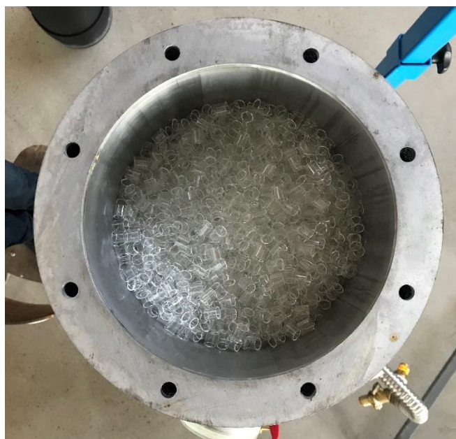
Obr. 25 – Výplň v podobě skleněných Raschigových kroužků umístěná v dolní části horní sekce kondenzátoru
