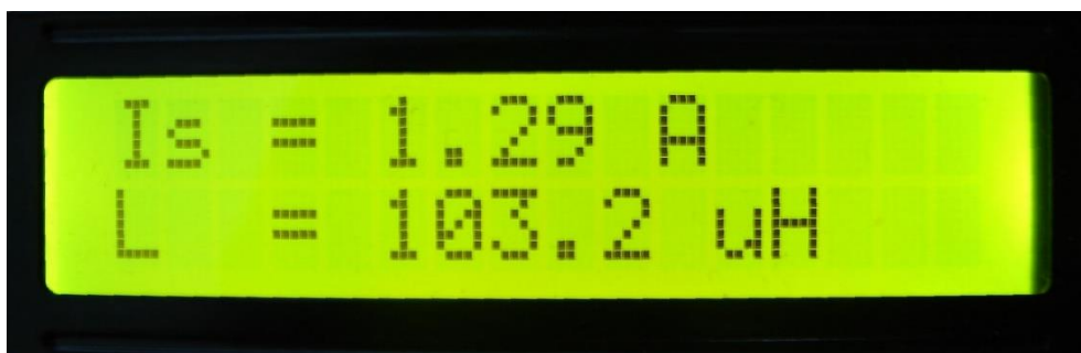
Naměřené hodnoty saturačního proudu a indukčnosti
