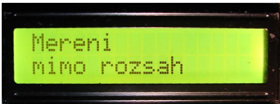
Detekce saturačního proudu nebo indukčnosti mimo měřicí rozsah
