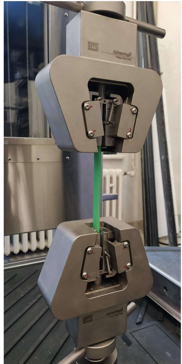
Obrázek 12: Trhací stroj (vlevo) a čelisti se vzorkem (vpravo)
