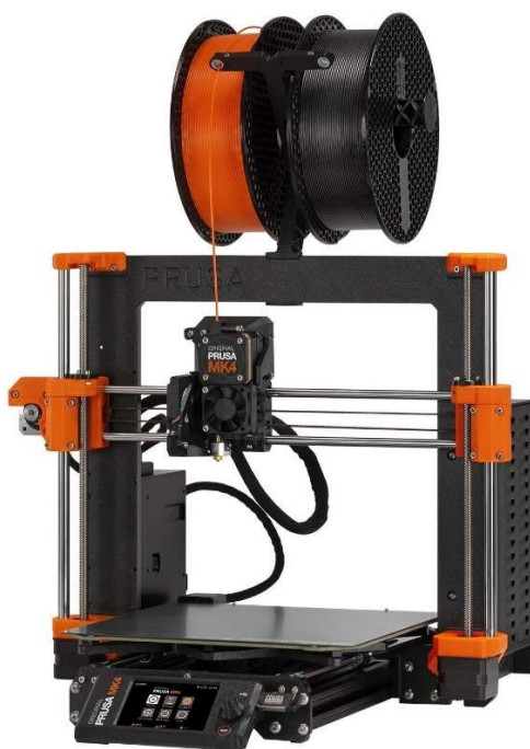
Obrázek 1: Prusa MK4 (Kartézská bed slinger tiskárna) [8]
