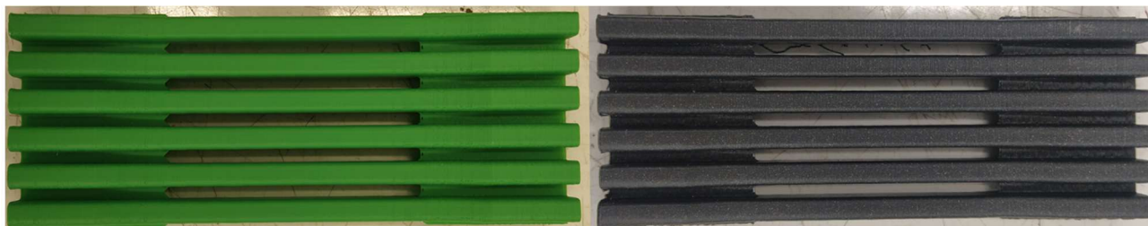
Obrázek 29: Model z PLA (zelený) a model z ASA (černý)
