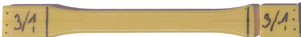
Obrázek 35: Dutý vzorek přetržený v upínací části
