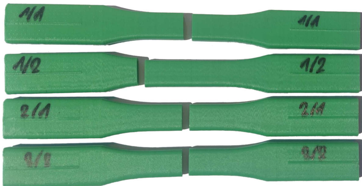
Obrázek 37: Přetržené vzorky s vnitřní drážkou
