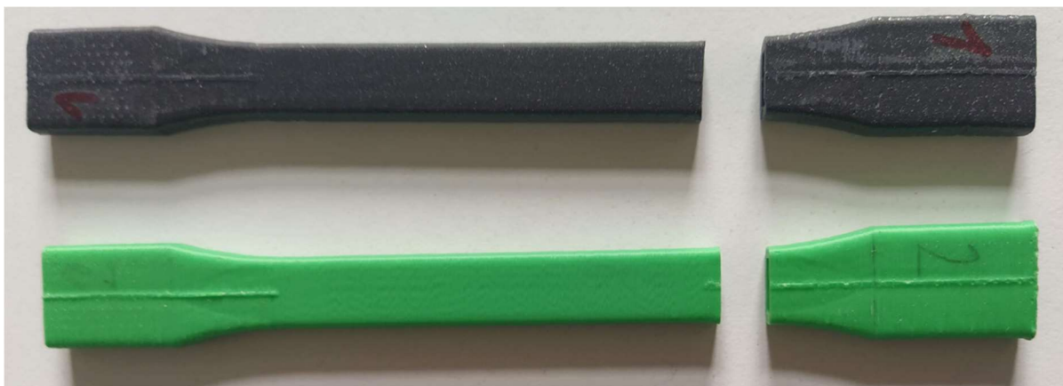
Obrázek 30: Přetržené vzorky z ASA (černý) a z PLA (zelený)
