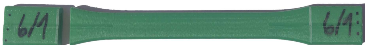
Obrázek 36: Přetržený dutý vzorek s plnými konci
