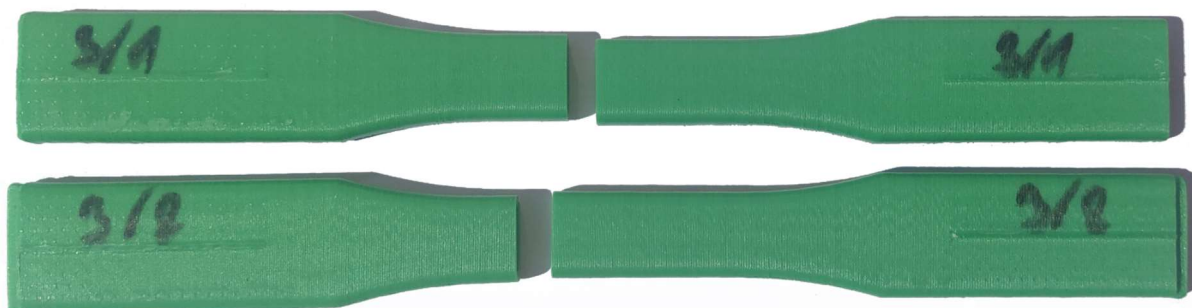
Obrázek 38: Přetržené čtvrté vzorky bez vnitřní drážky
