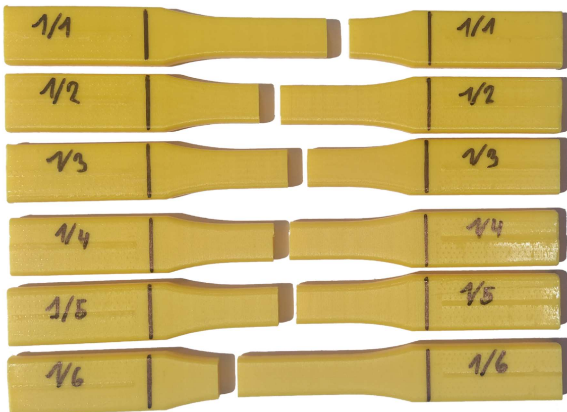
Obrázek 39: Přetržené páte vzorky dle normy
