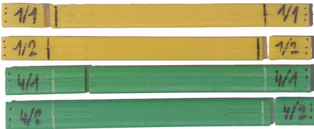
Obrázek 33: Přetržené vzorky obdélníkového průřezu
