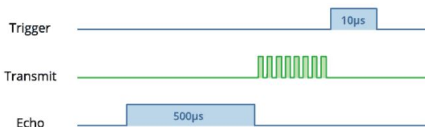
Obrázek 4.9: Průběh činnosti ultrazvukového senzoru HC-SR04 [15]
