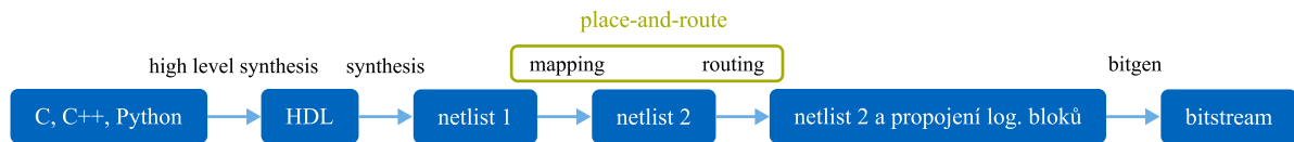
Obr. 4 - 4 Blokové schéma převodu aplikace naprogramované v procedurálním jazyce na bitstream, kterým je konfigurováno FPGA.
