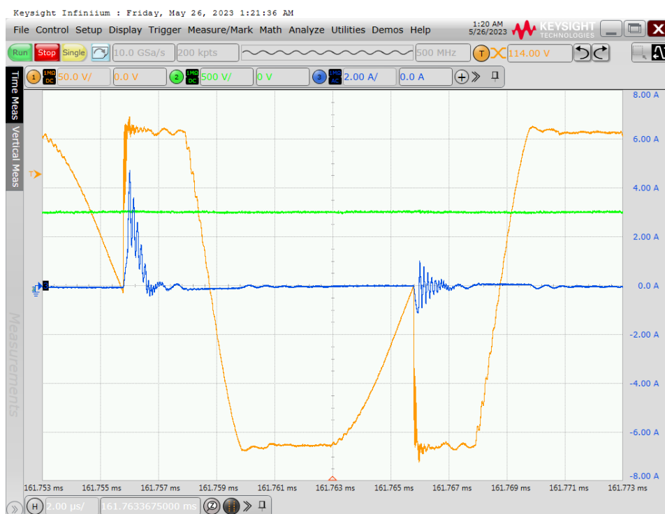
Obrázek B.4: Proud sekundárním vinutím, V_{out}=700\text{ V} , R_Z=1,2\text{k}\Omega
