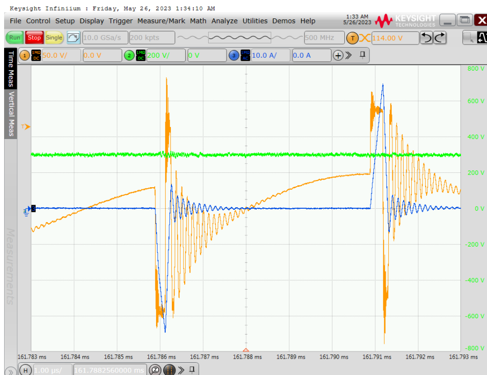
Obrázek B.1: Proud primárním vinutím, V_{out}=300\text{ V} , R_Z=3,7\text{k}\Omega
