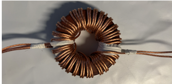
Obrázek 6.4: Transformátor měniče napětí
