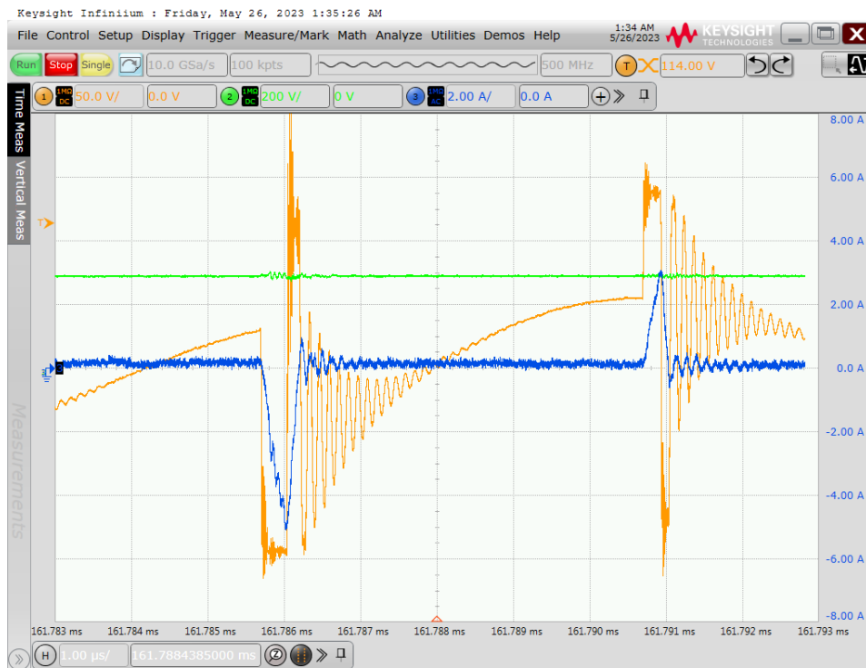
Obrázek B.2: Proud sekundárním vinutím, V_{out}=300 V, R_Z=3,7k\Omega
