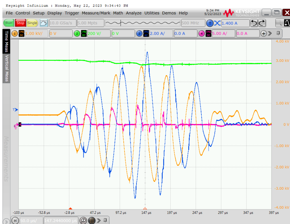
Obrázek C.12: Průběhy na sonotrodě d=25 mm, V_{out}=600 V, 12 pulsů
