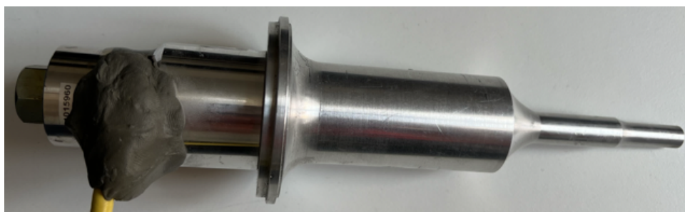
Obrázek A.2: Piezoelektrický měnič pro ultrazvukové čističky s přidanou mechanickou soustavou
