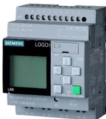
Obr. 1.3 Jednoduchý typ PLC [8]
