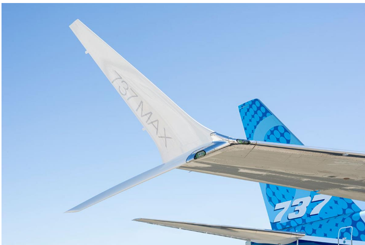
Obr. 12 Scimitarový winglet na letounu Boeing 737 MAX [23]
