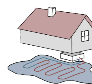
Obrázek 44 Tepelné čerpadlo voda/voda, voda z vodního toku nebo plochy (vlastní zpracování dle Beranovský et al., 2003)
