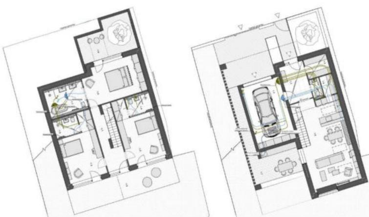
Systém řízeného větrání s rekuperací. Hlavní jednotka VZT se systémem ZZT umístěna v garáži pod stropem. Odsud je pomocí potrubí a distribučních prvků vedeno dle schématu zde či v
