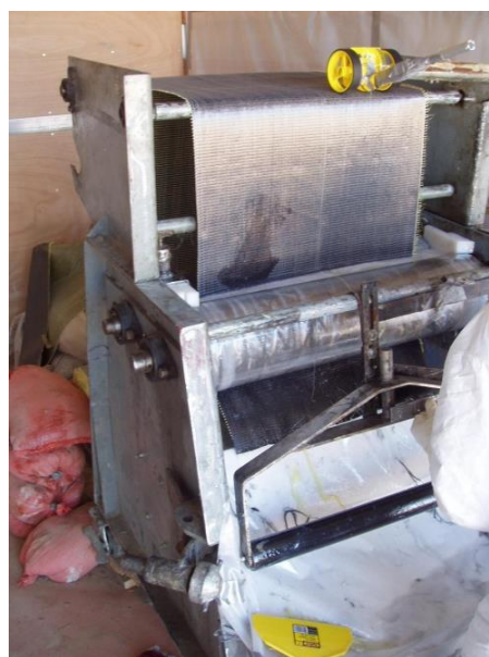
Obrázek č. 3: Ruční nanesení pryskyřice na tkaninu (9) Obrázek č. 4: Strojové nanesení pryskyřice na tkaninu (9)
