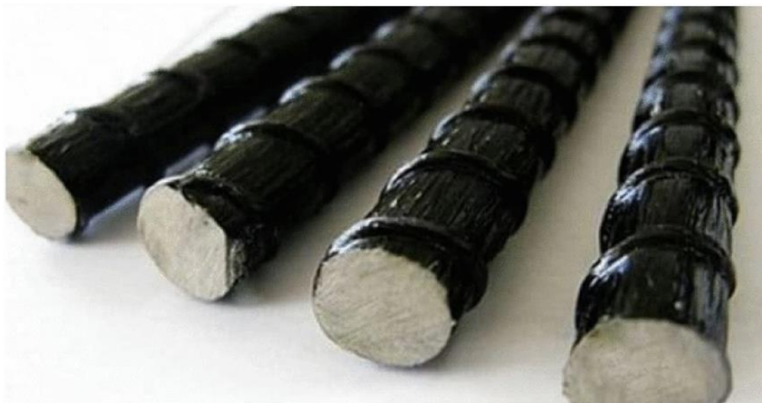
Obrázek č. 14: Ocelová výztuž omotaná CFRP (7)
