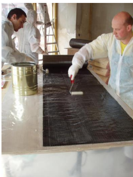
Obrázek č. 3: Ruční nanesení pryskyřice na tkaninu (9) Obrázek č. 4: Strojové nanesení pryskyřice na tkaninu (9)
