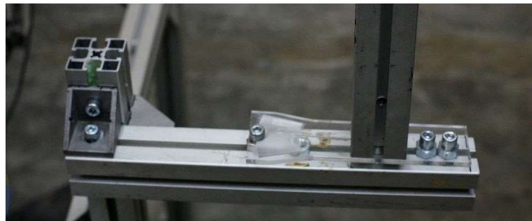
Obr. 4.2.3: Ciferník mechanismu nastavování úhlu náběhu a jeho uchycení k rámu
