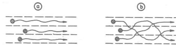
Obr. 2.1.4 schéma a) laminárního proudění, b) turbulentního proudění [8]
