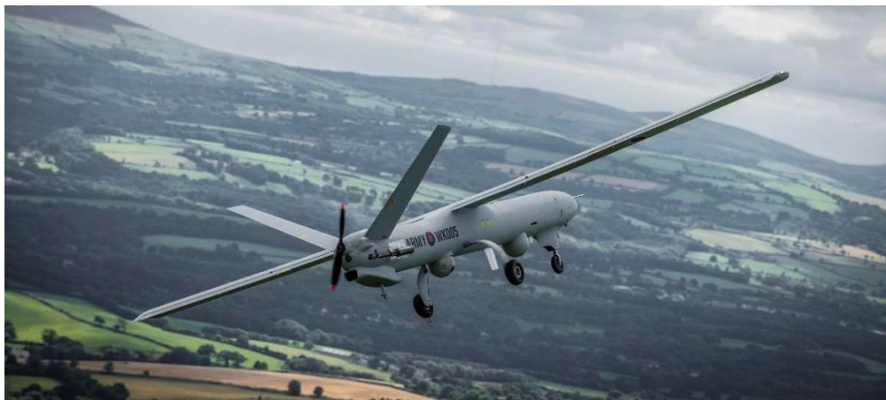
Obr. 3.6.1: Britský UAV armádní dron Watchkeeper s motýlkovými ocasními plochami [33]
