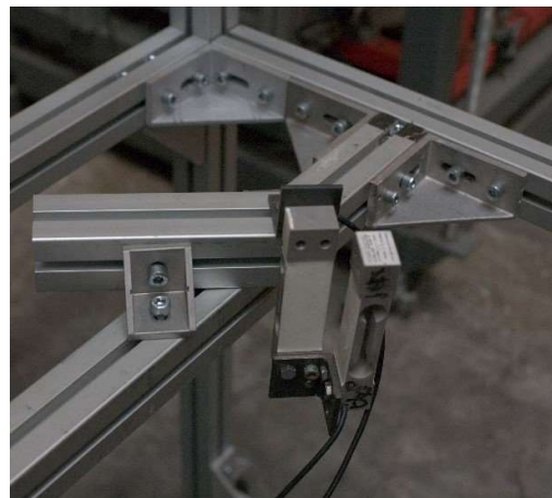
Příloha 7: Detail uchycení tenzometrů k rámu umožňující jejich rotaci
