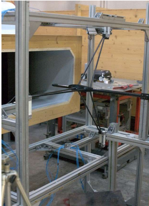
Příloha 2: Umístění aerodynamických vah během měření
