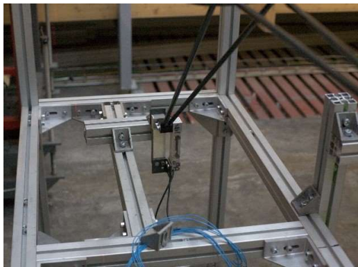
Příloha 4: Detail konstrukce aerodynamických vah
