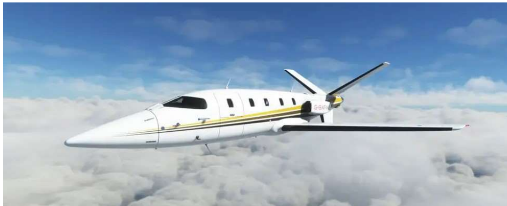
Obr. 3.6.2: Business jet LearJet Lear Fan 2100 s uspořádáním ocasních ploch do Y a tlačnou vrtulí [34]
