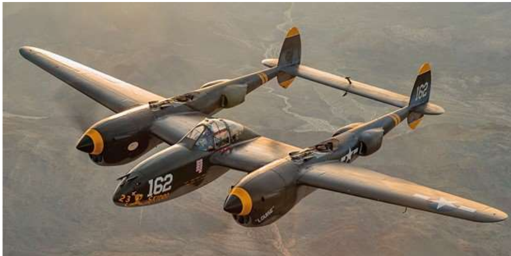
Obr. 3.5.1: Americký armádní dvoutrupý bojový letoun z druhé světové války Lockheed P-38 Lightning se zdvojenými ocasními plochami [30]
