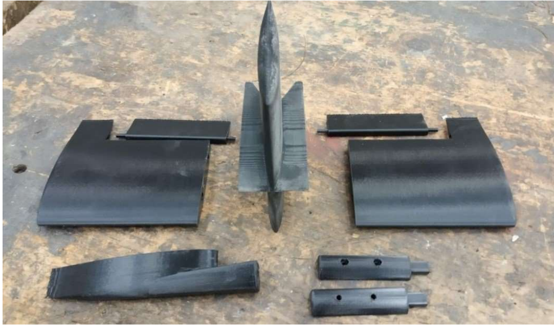
Obr. 4.3.8: Model ocasních ploch před složením, uspořádání do X
