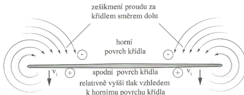
Obr. 2.1.9: Tlakový rozdíl mezi horním a dolním povrchem křídla, indukovaný vír, upraveno [3]
