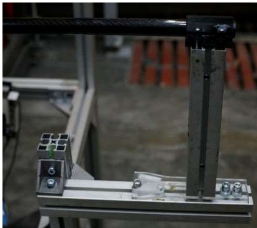
Příloha 6: Detail mechanismu nastavování úhlu náběhu modelů
