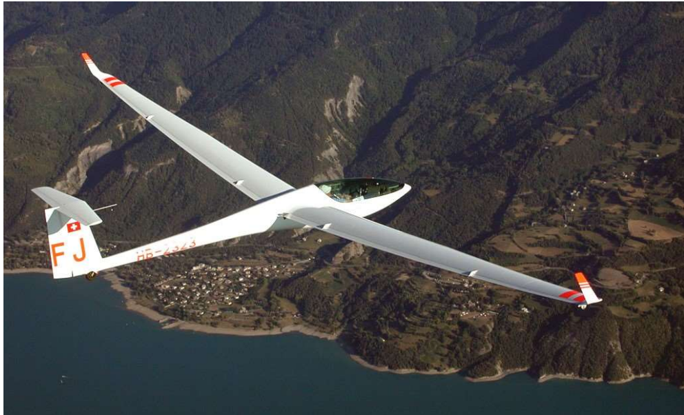
Obr. 3.3.1: Kluzák DG 800 B s ocasními plochami typu T [28]
