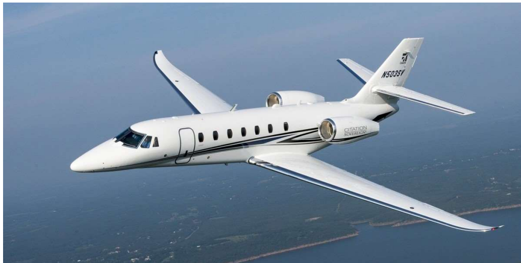
Obr. 3.4.1: Business jet Cessna Citation Sovereign plus s křížovým uspořádáním ocasních ploch [29]
