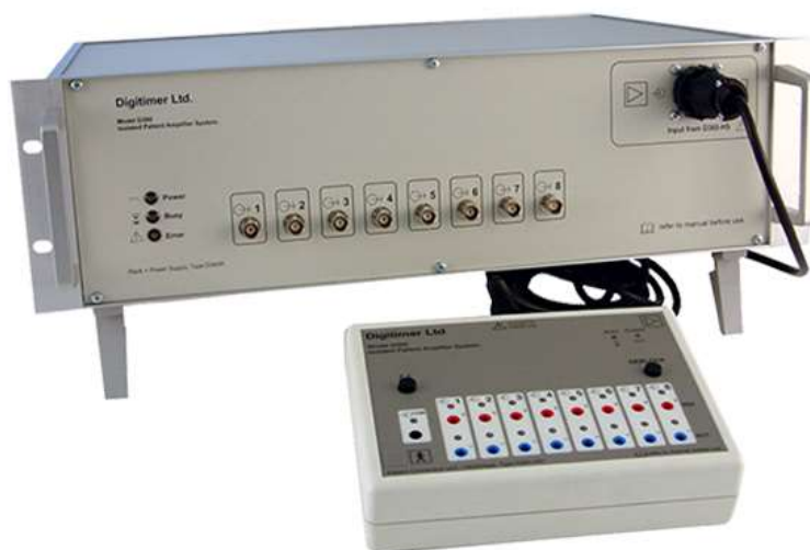
Obrázek 13 - zesilovač biologických potenciálů Digitimer D 360
