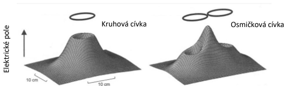
Obrázek 7 - elektrické pole kruhové a osmičkové stimulační cívky
