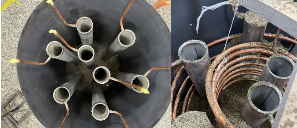
obr. 35: Úložiště tepla s kamenným prachem a dvěma integrovanými tepelnými výměníky (měděný had a trubka v trubce)
