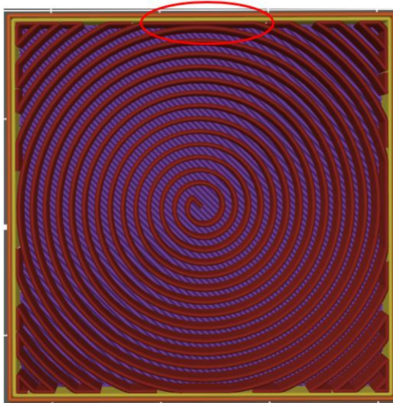
Obrázek 46: Řez testovacím modelem po proběhlém slicování s nastavenou výplní 35 % arcimedean chords
