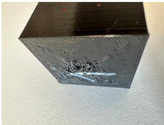
Obrázek 44: Propadlá vrchní stěna testovacího tělesa s 5% výplní archimedean chords
