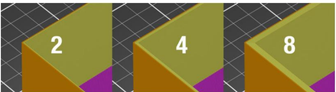
Obrázek 13: Ukázka tloušťky stěny při různém počtu perimetrů [18]
