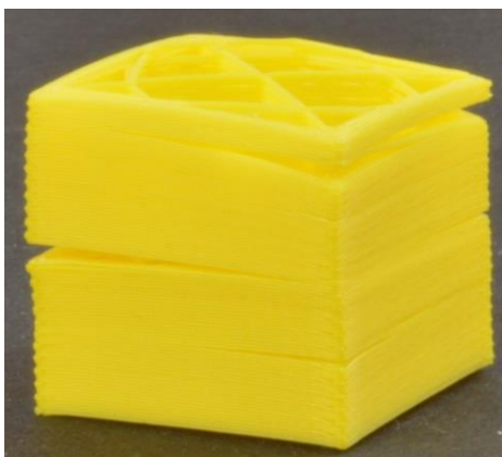
Obrázek 14: Oddělení vrstev tisku, způsobené špatnou adhezí [22]
