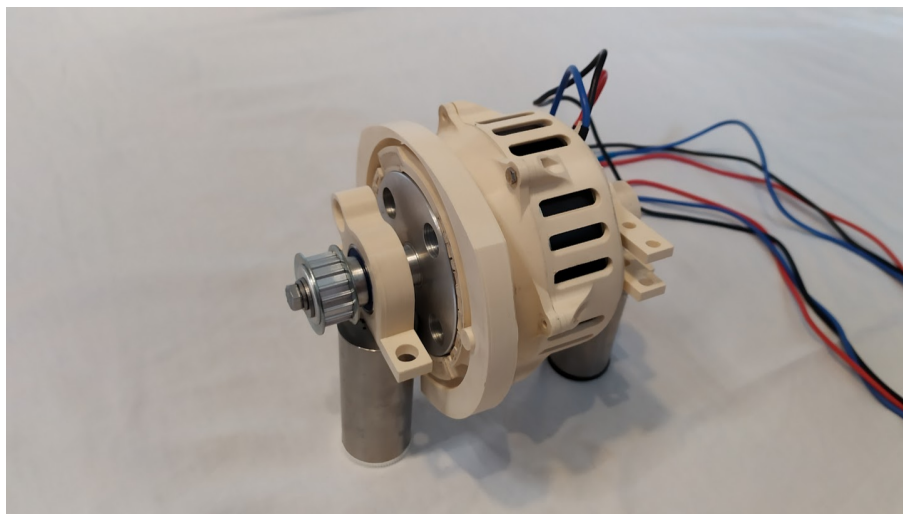
Obrázek 15: Těleso dynamometru na kyvných podporách před montáží.
