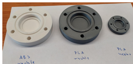
(b) FDM výtisk nábojů ve zmenšeném a skutečném měřítku.
