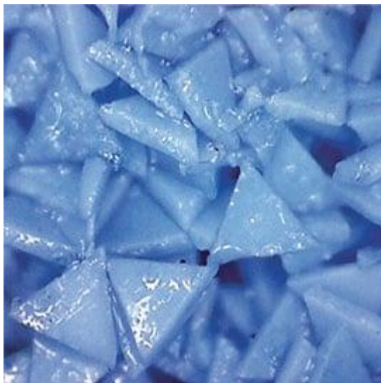
Obr. 16: Trojúhelníková zrna Cubitronu II [21]
