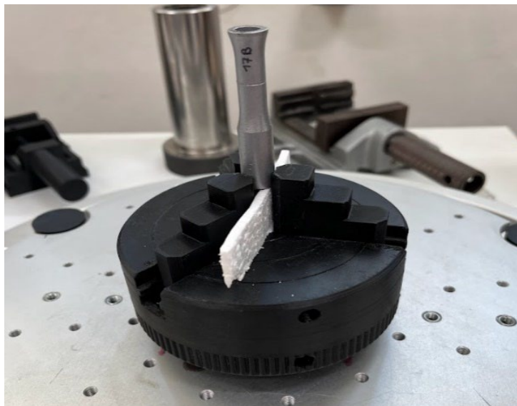
Obrázek 21 Poloha vzorku při skenování
