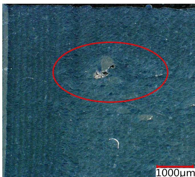
Obrázek 45 Zdeformované taveninové lázně v místě velkorozměrového póru
