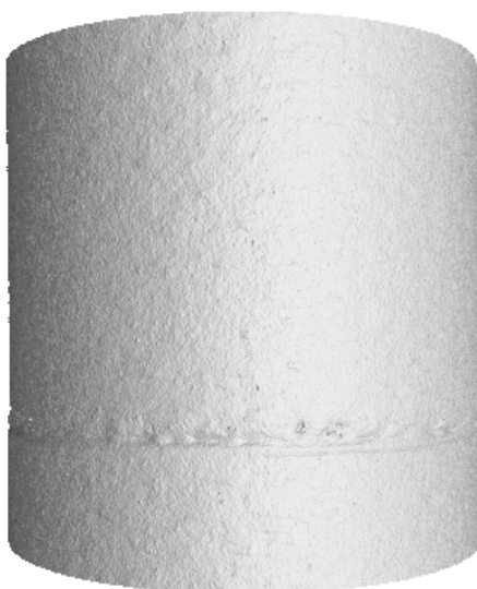
Obrázek 27 Vrub u vzorku 25 C
