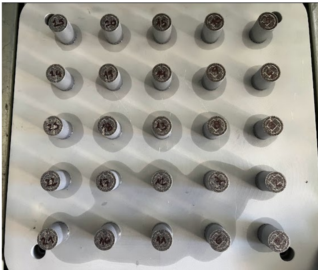
Obrázek 34 Označení vzorků před odstraněním ze stavební palety
