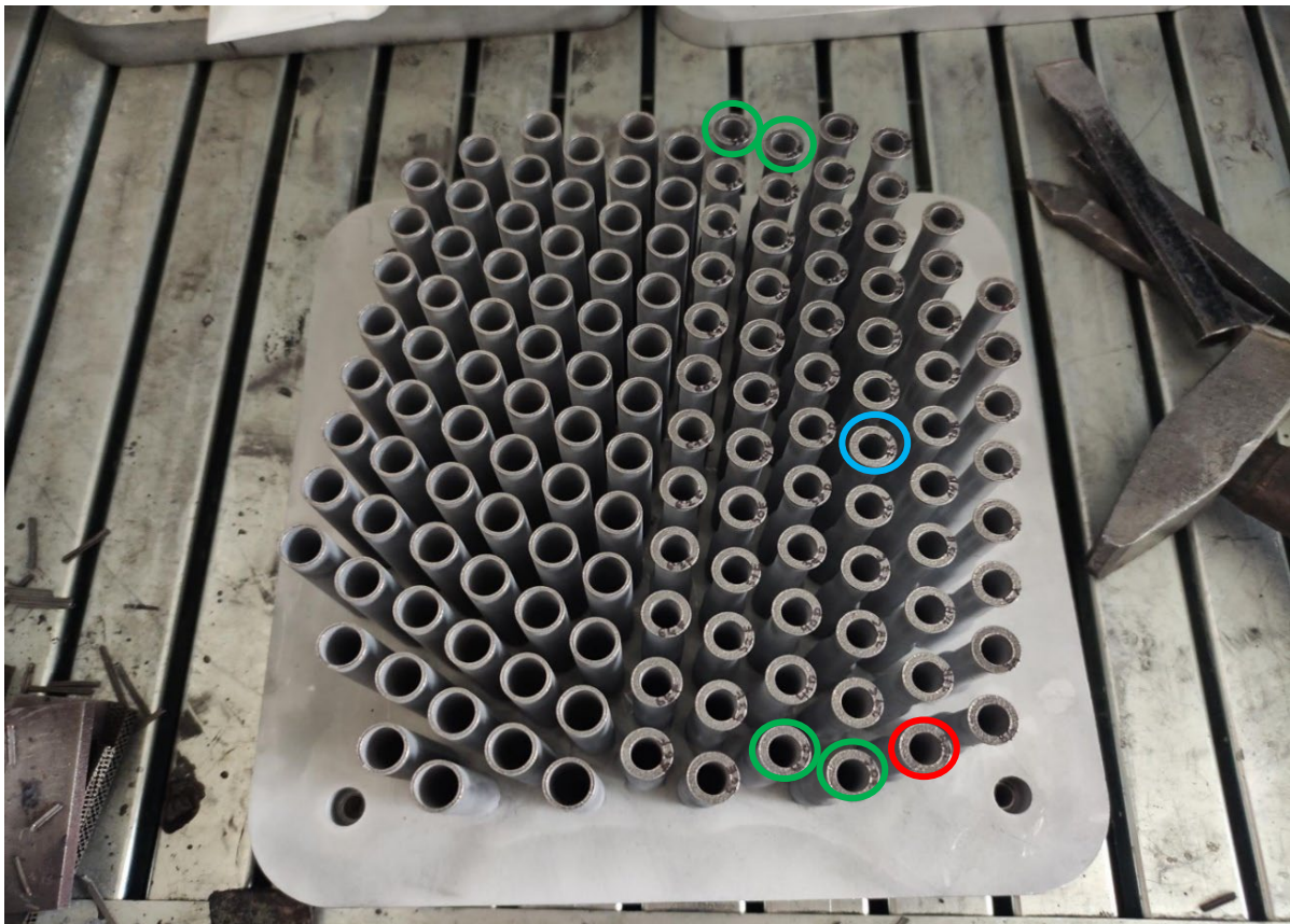
Obrázek 20 Umístění vzorků na stavební paletě
