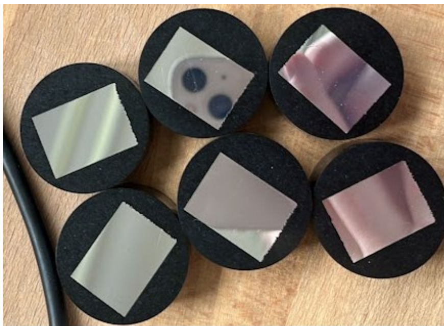
Obrázek 39 Připravené metalografické vzorky pro pozorování na optickém mikroskopu
