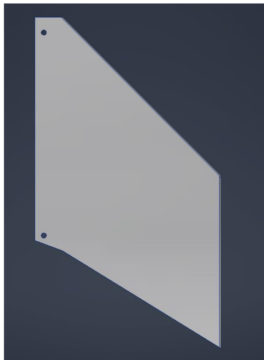
Obr. 3 - CAD model stabilizačního kormidla
