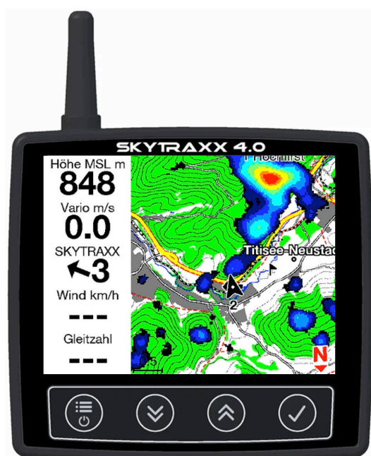
■ Obrázek 3.6 SKYTRAXX 4 se zobrazením základních údajů o letu, topologických map a srážkového radaru. Získáno z https://en.skytraxx.eu
