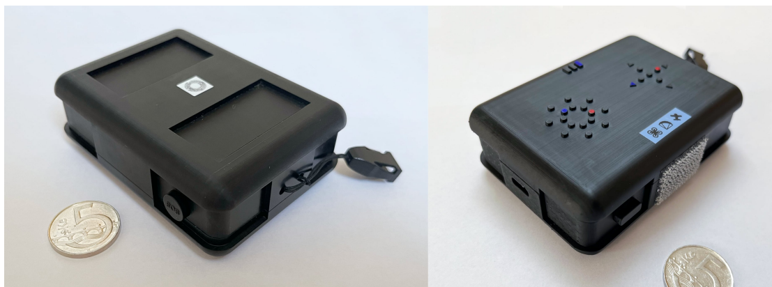
■ Obrázek 6.11 První prototyp šasi zařízení Pilottag, vlevo ze spodní strany, vpravo z horní.
