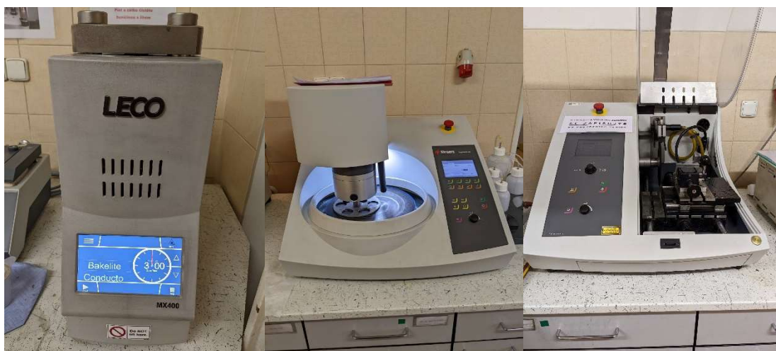
Obr. 34 Lisovací zařízení LECO MX400 (vlevo), metalografická bruska Tegamin 30 (uprostřed) a metalografická pila Struers Secotom 60 (vpravo)
