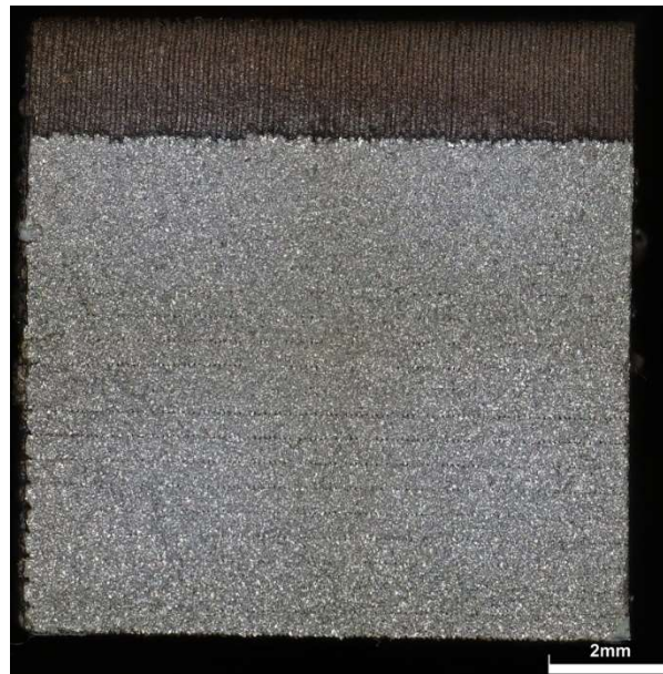
Obr. 33 Lomová plocha vzorku H6 - BMD
