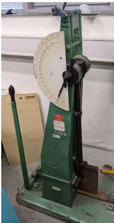
Obr. 30 Kyvadlové kladivo pro zkoušku rázem v ohybu
