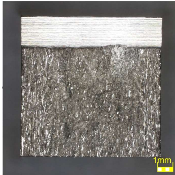
Obr. 31 Lomová plocha vzorku H3 – DMLS
