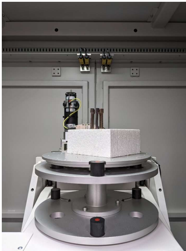
Obr. 20 Umístění vzorků v tomografu
