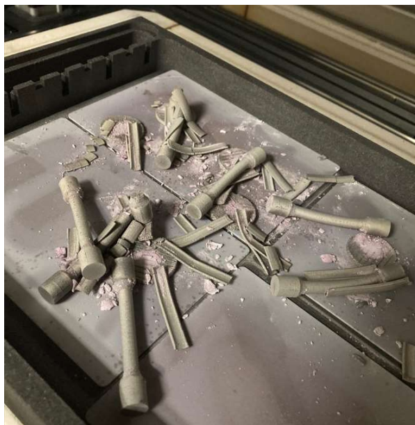
Obr. 15 Výsledek sintrování vertikálních vzorků pro zkoušku tahem
