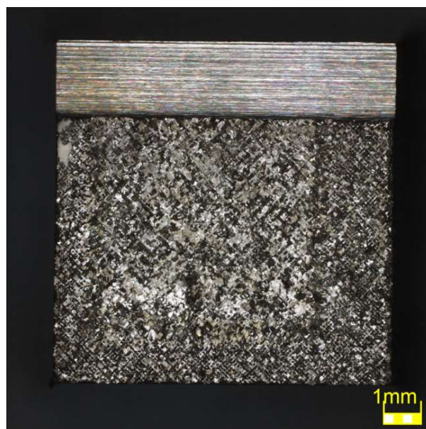
Obr. 32 Lomová plocha vzorku V1 - DMLS
