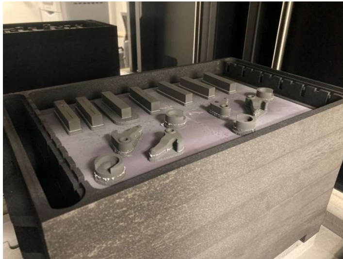
Obr. 14 Umístění vzorků pro zkoušku rázem v ohybu na keramických destičkách v grafitových podnosech
