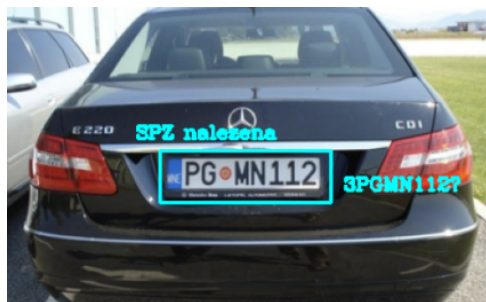
Obrázek 2.8: Detekce SPZ pomocí algoritmu YOLOv8 naučeného na vlastních datech
