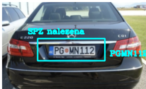
Obrázek 2.7: Detekce SPZ pomocí HAAR příznaků (rohý) a kaskádového klasifikátoru
