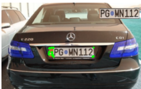
Obrázek 2.6: Detekce SPZ pomocí obrysů
