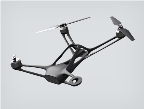
Obrázek 28 vlevo tělo quadrokoptéry vytvořené generativním designem [39], 7 vpravo Koncept meziplanetárního modulu GAMMA [32]
