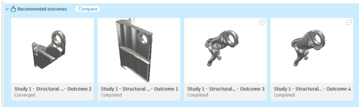
Obrázek 14 vygenerované návrhy, zleva- pro víceosé obrábění, dvou ose řezání, pro tisk ze slitiny Al, pro tisk z PA12
