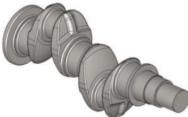
Obrázek 22 topologická optimalizace na klikovém hřídeli [41]
