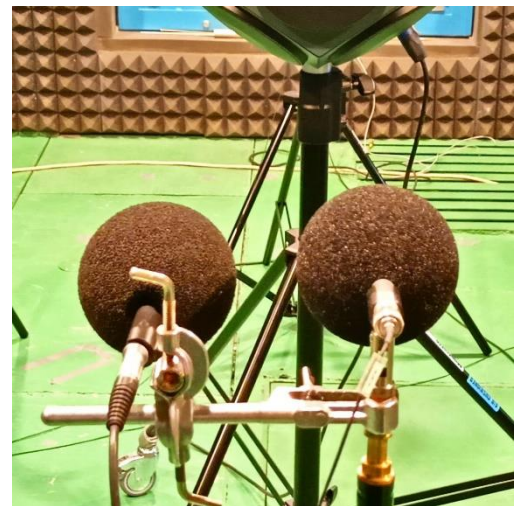
Obr. 3.4 – Připevnění mikrofonu zvukoměru k mikrofonu č. 5
