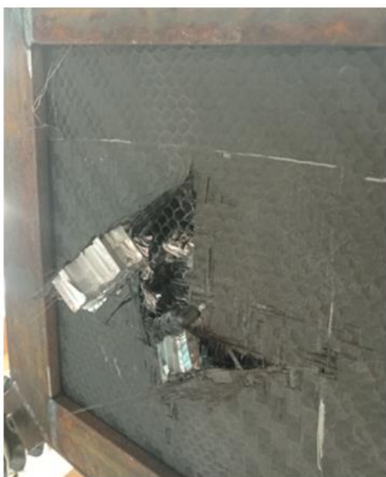
Obrázek 32: Vzorek se směsí epoxidu ihned po vytržení
