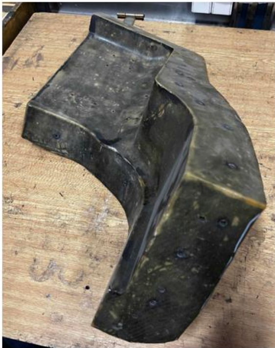
Obrázek 12: Výsledná uhlíková část formy na monokok
