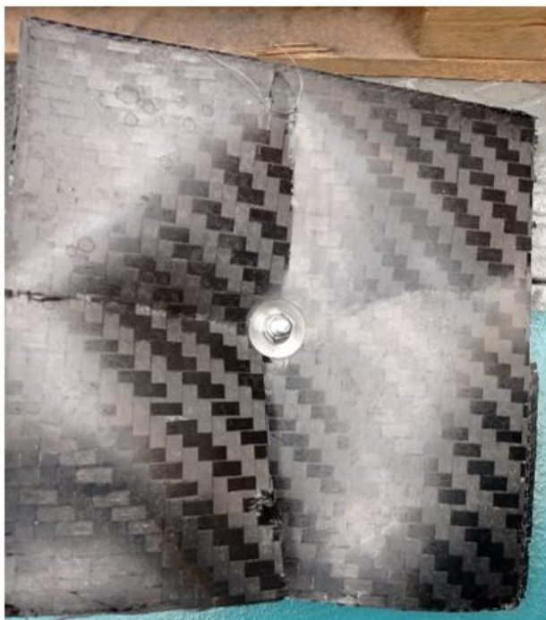
Obrázek 28: Deformovaný vzorek s PA66 GF30
