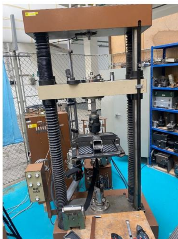
Obrázek 25: Testovaný vzorek na trhacím stroji
