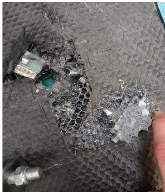
Obrázek 33: Detail na dleminaci vzorku se směsí epoxidu
