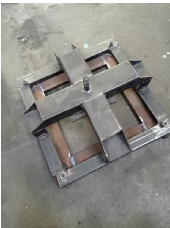
Obrázek 24: Svařený přípravek pro uchycení vzorů
