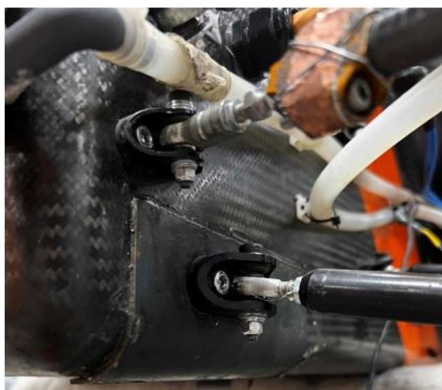
Obrázek 18: Oprava monokoku po vytržení insertu
