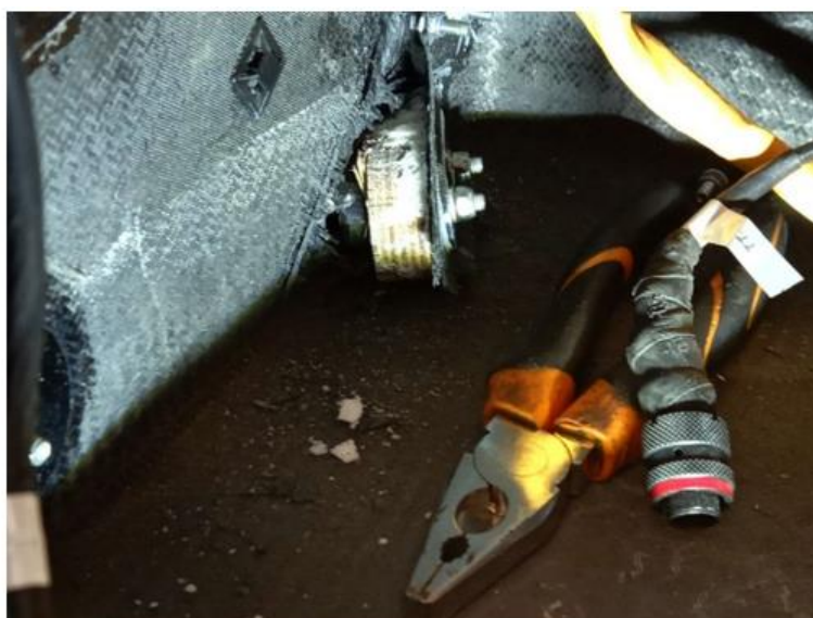
Obrázek 17: Pohled na vytržený insert
