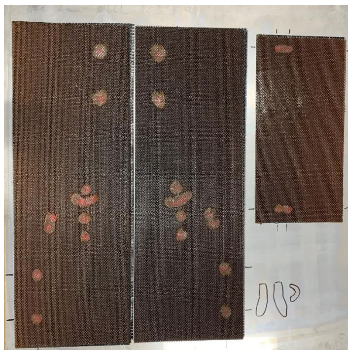
Obrázek 20: Nomexová voština s inserty ze směsi epoxidu
