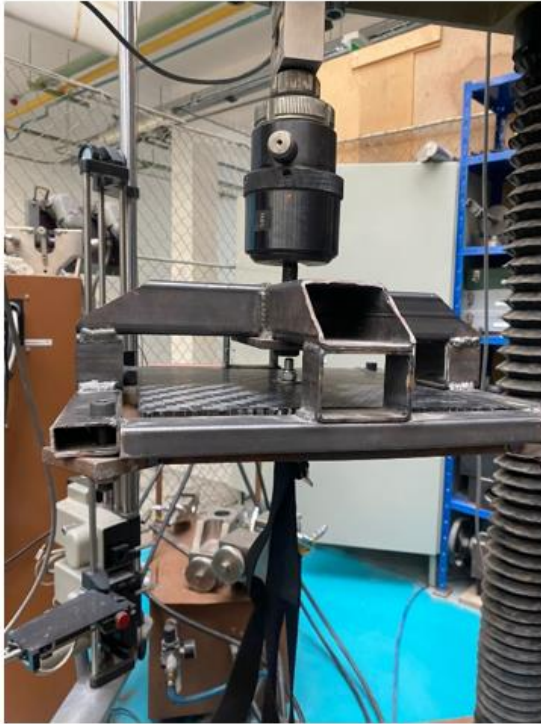
Obrázek 26: Detail upevnění držáku pro testování vzorků
