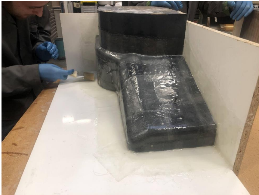
Obrázek 11: Nanášení vrstvy skla na formu pro monokok
