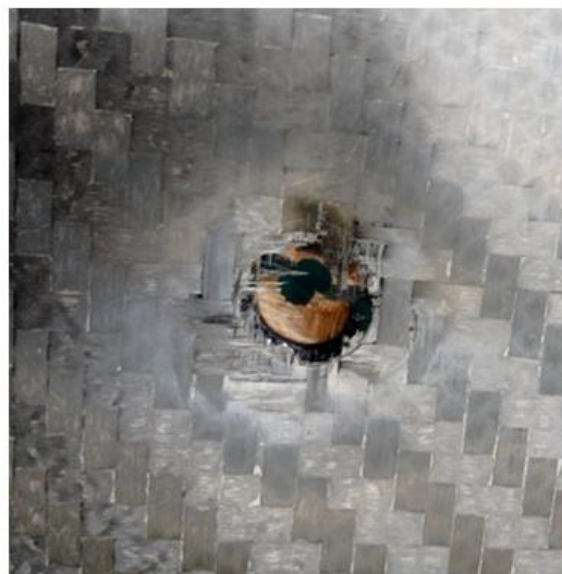
Obrázek 30: Detail díry a zbytku překližky po vytrnutí insertu Obrázek 31: Detail díry a zbytku překližky po vytrnutí insert
