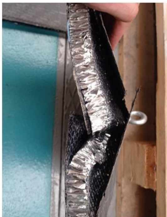
Obrázek 29: Detail delaminace vzorku s PA66 GF30
