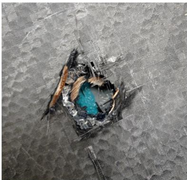
Obrázek 30: Detail díry a zbytku překližky po vytrnutí insertu Obrázek 31: Detail díry a zbytku překližky po vytrnutí insert
