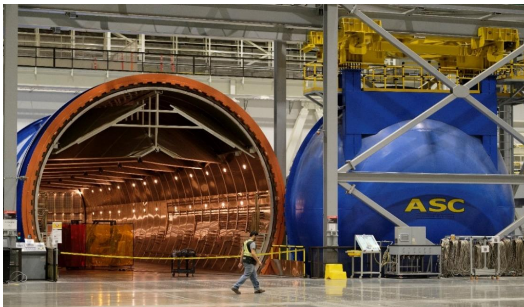
Obr. 20: Příklad obřího autoklávu pro výrobu křídel letounu Boeing 777X [42]
