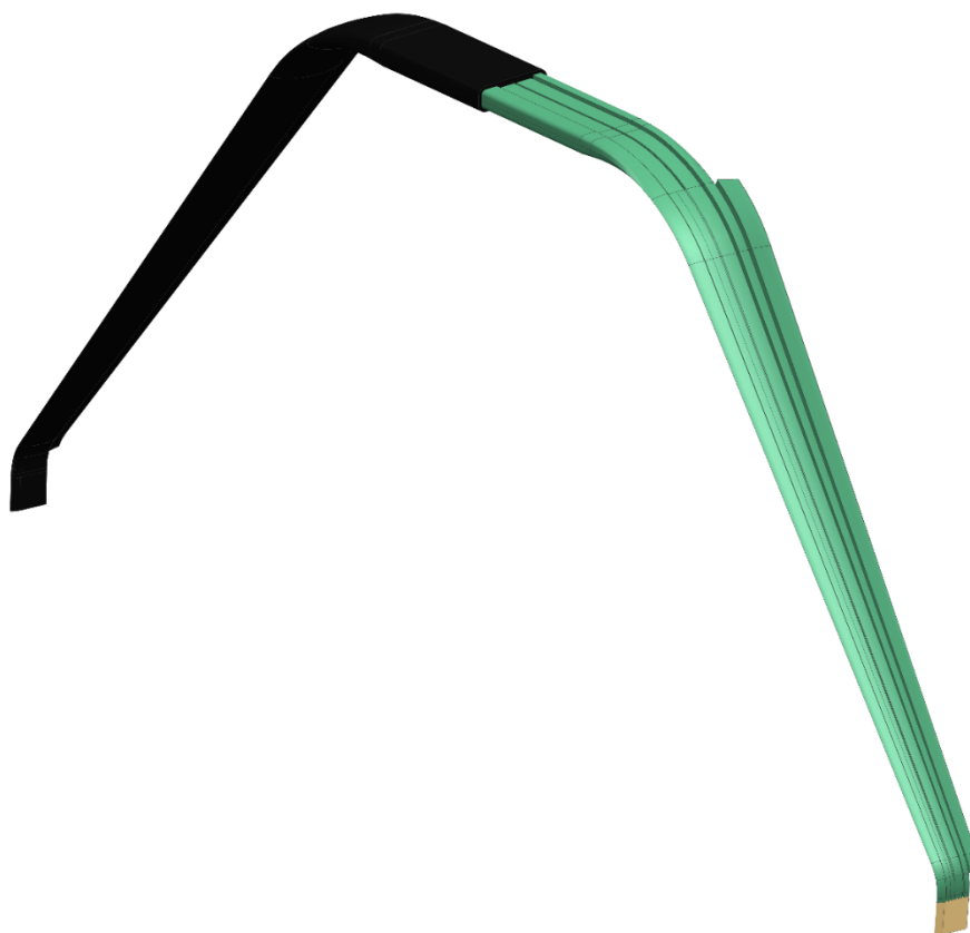
Obr. 42: 3D model pěnových jader a překližkových insertů
