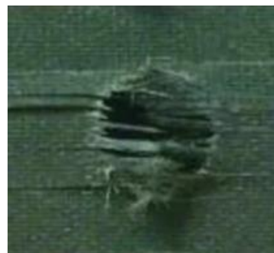
Obr. 23: Delaminace na výstupu díry způsobená vrtáním [61]
