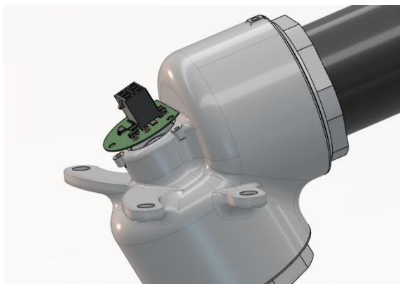
obr. 11: Vlastní senzor natočení řízení v monopostu FSE.11
