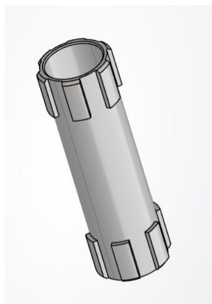
obr. 22: Vertikální spojovací hřídel předchozí generace FSE.11
