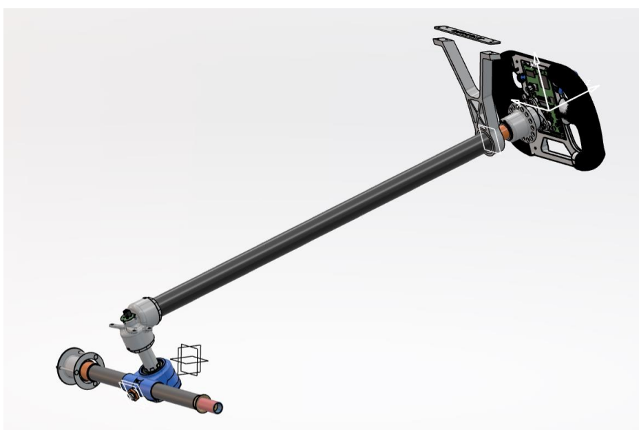
obr. 1: Systém řízení FSE.11
