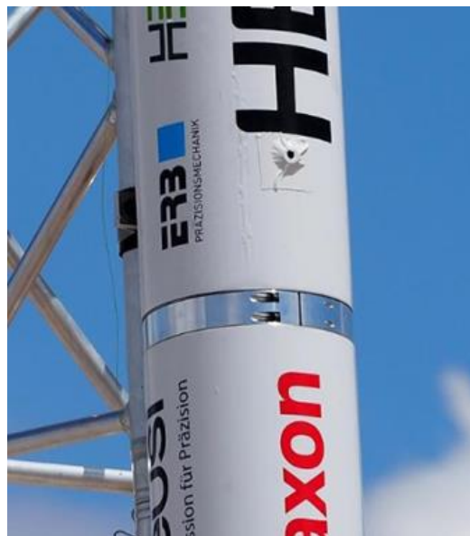
Obrázek 15: Spoj V-band na raketě Helvetia [26]
