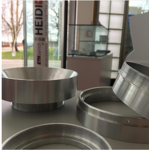
Obrázek 7: Závítové spojení týmu Aris [9]
