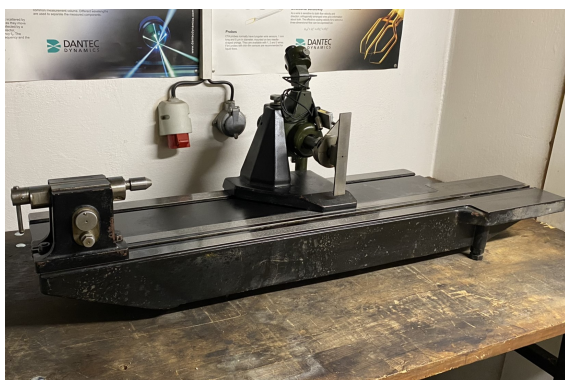
Obrázek 5.1: Lože měřicího zařízení s koníkem a optickou hlavou pro měření zdvihu
