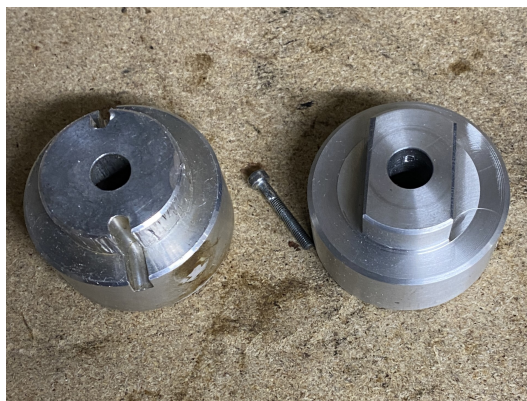
Obrázek 5.9: Porovnání původní a nové závitové redukce rotačního snímače
