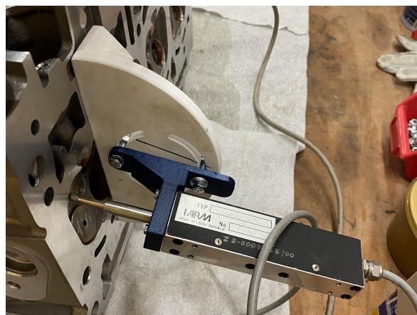
Obrázek 4.5: Lineární snímač upnutý k hlavě motoru pomocí přípravků vyhotovených 3D tiskem
