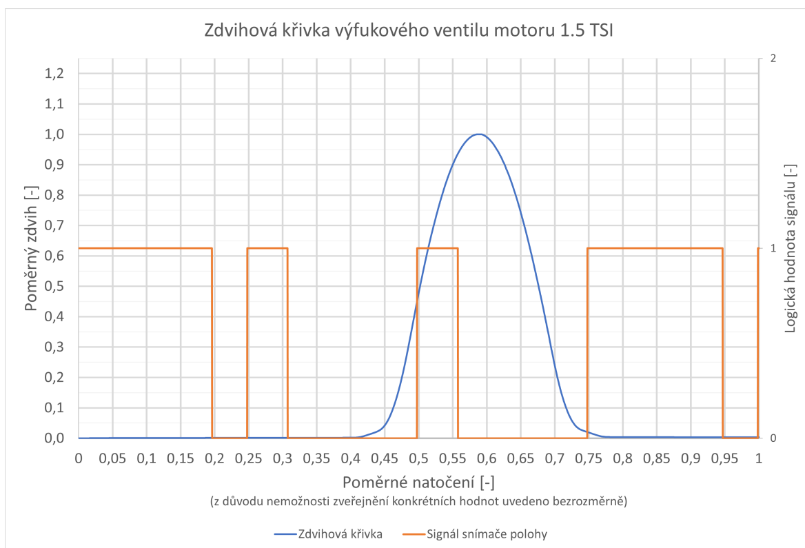
Obrázek B.2: Zdvihová křivka výfukového ventilu motoru 1.5 TSI
