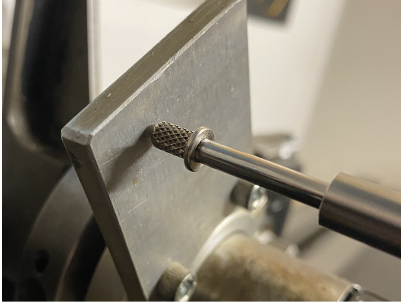
Obrázek 5.6: Destička pro přenos zdvihu na lineární čidlo
