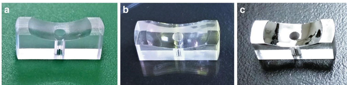
Obrázek 22, a) Vytištěná čočka b) Vytištěná čočka po ošetření směsí polymerů c) Vytištěná čočka po ošetření směsí polymerů a po pokovování. (56)
