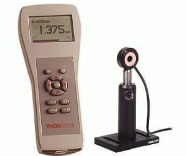
Obrázek 65 Měřič výkonu a senzor thorlabs PM120 (70)
