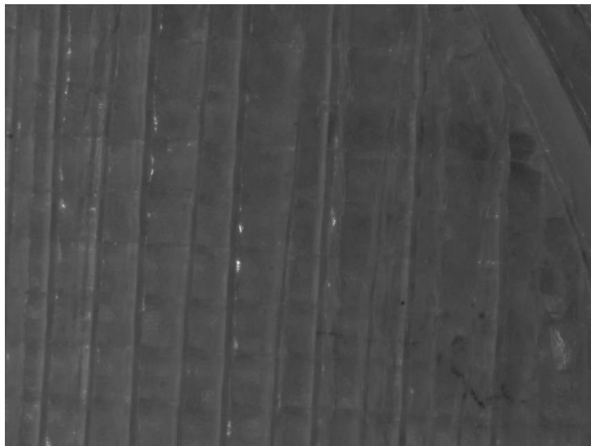
Obrázek 58 Hladká strana vzorku 10 pod mikroskopem (48x zvětšený)
