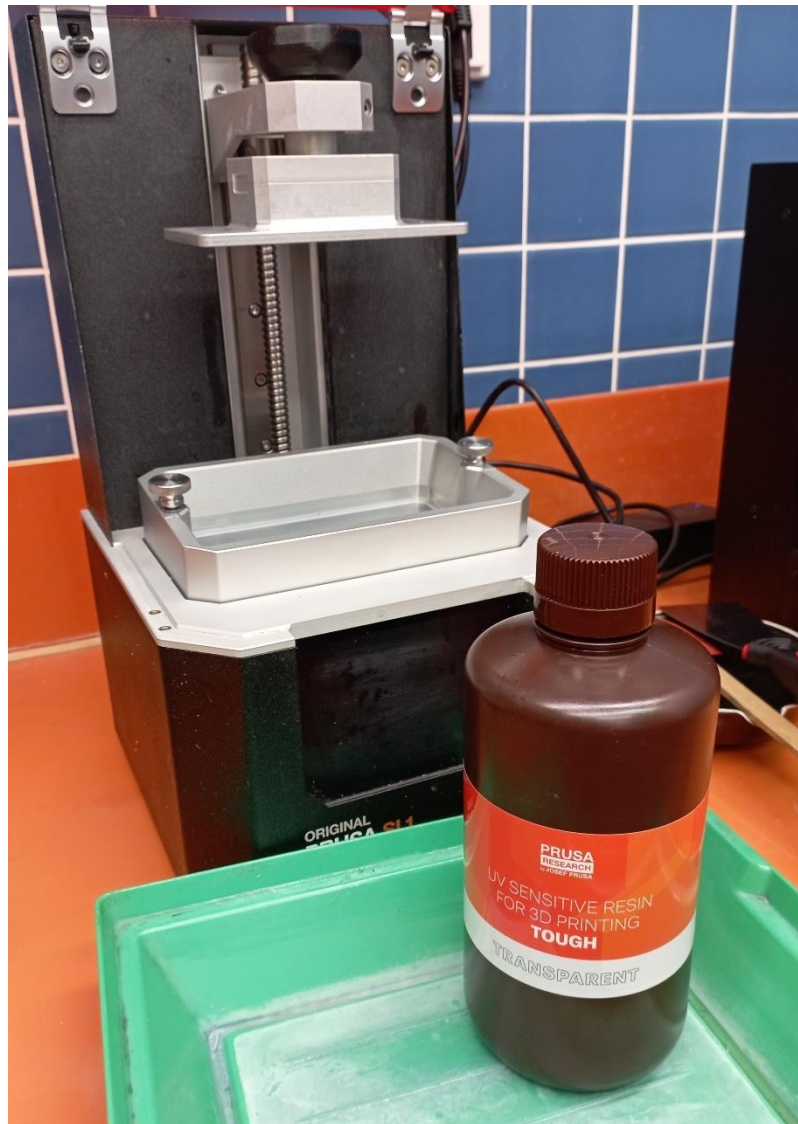
Obrázek 39 SLA tiskárna a pryskyřice do ní využita
