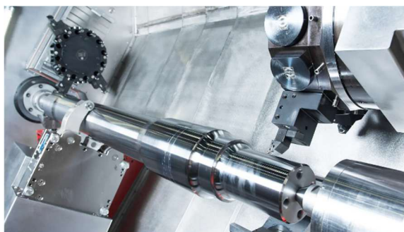
Obr. 57 - Obrábění železniční nápravy na číslicově řízeném soustruhu (KOVOSVIT MAS) [38]
