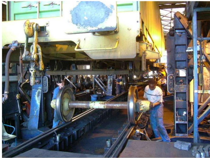
Obr. 1 - Výměna dvojkolí nákladního vozu v Cerbére [6]
