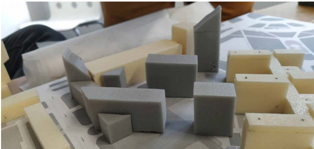
01 Fyzický model z běžně dostupných materiálů pro rychlou představu navrhované zástavby zdroj: fotoarchiv autora práce
