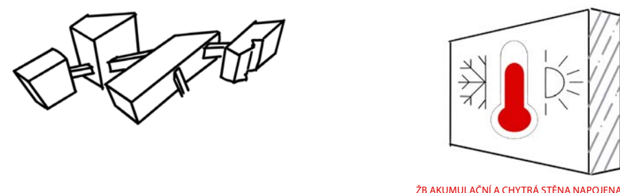
ZB AKUMULAČNÍ A CHYTRÁ STĚNA NAPOJENA NA TEPELNÉ ČERPADLO PRO CHLAZENÍ A VYTÁPĚNÍ ATRIA
